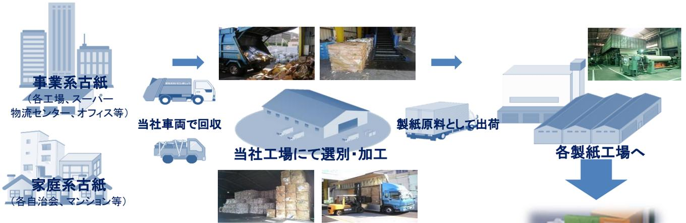
回収又は持ち込まれた古紙を選別し、大型プレス機へ投入し1トン程度に圧縮します。梱包された古紙は、品種ごとにヤード・倉庫内に保管されます。大型車両1車単位で出荷され、製紙メーカーで製紙原料として利用されます。株式会社天馬は、直納問屋として大手メーカーを中心に古紙（製紙原料）を安定供給しています。
