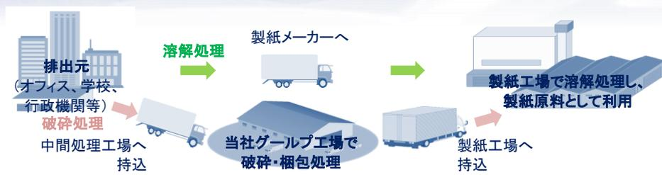
処理工程① 製紙メーカーでの直接溶解処理 ⇒ 処理能力 1時間あたり 6,000kg
